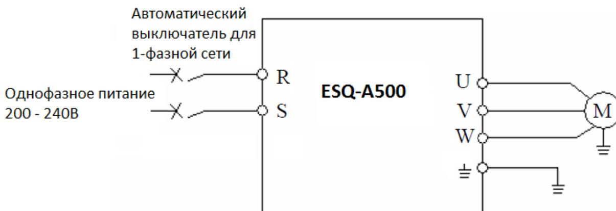
Рисунок 2. Однофазная схема подключения мотора к ЧП
