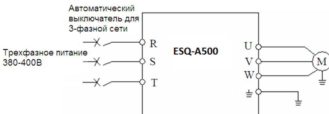
Рисунок 1. Трехфазная схема подключения мотора к ЧП
